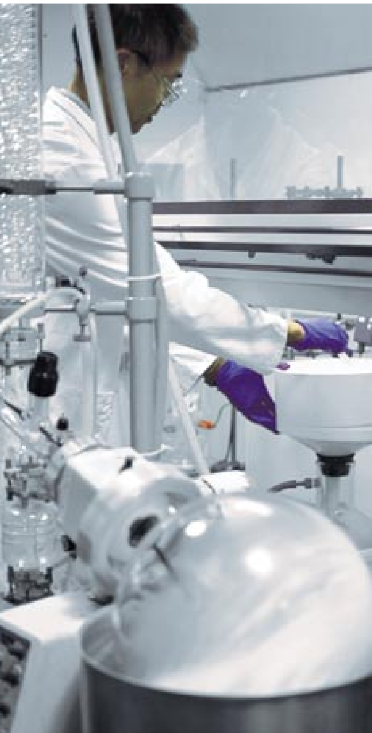
Filtration eines Arzneistoff-Zwischenproduktes während der Laborsynthese nach GMP-Standards
